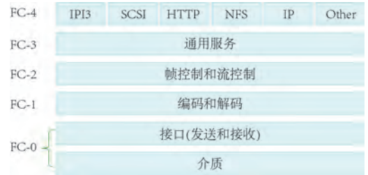
图 2 FC 协议分层模型
